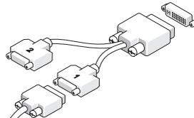
**d** VGA-Kabel mit DVI-Adapter
